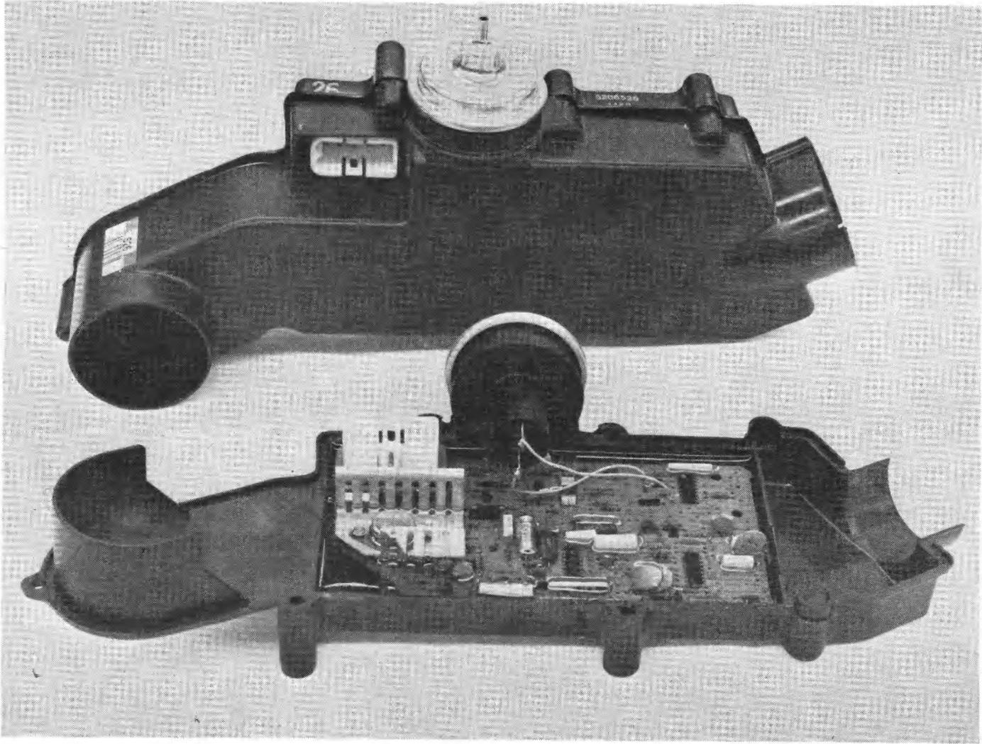
Figure 59 ELECTRONIC SPARK ADVANCE (ESA) MODULE
