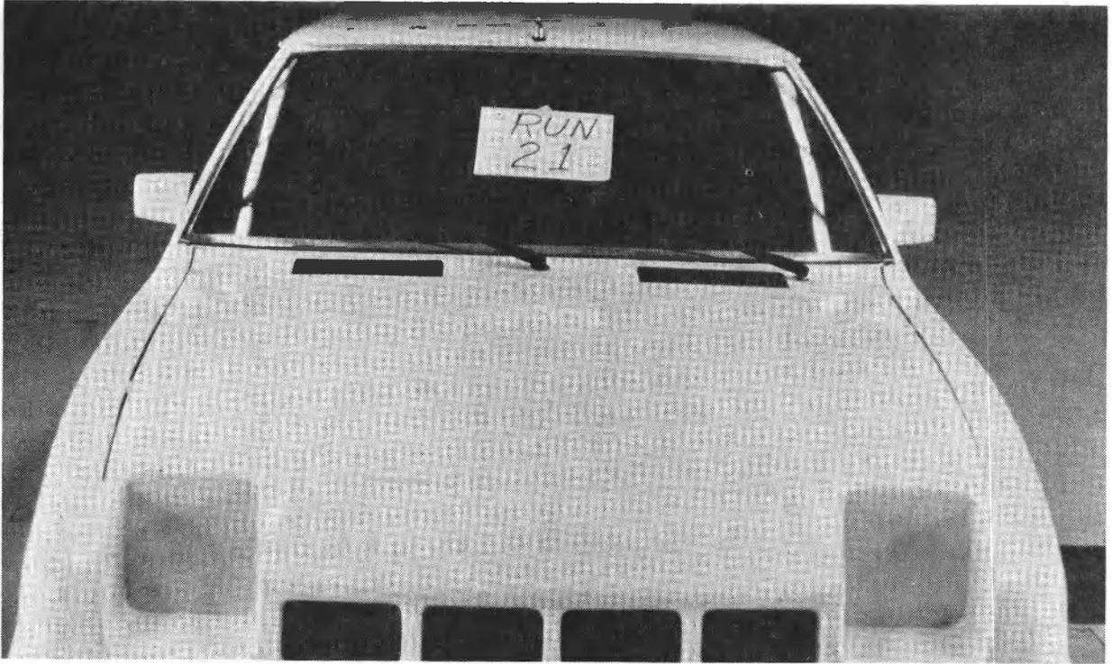
**Figure 103 AERODYNAMIC MIRRORS**
