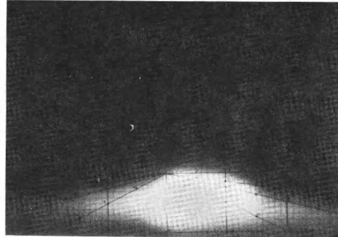
**Figure 54 STANDARD TUNGSTEN SEALED BEAM LOW BEAM**
