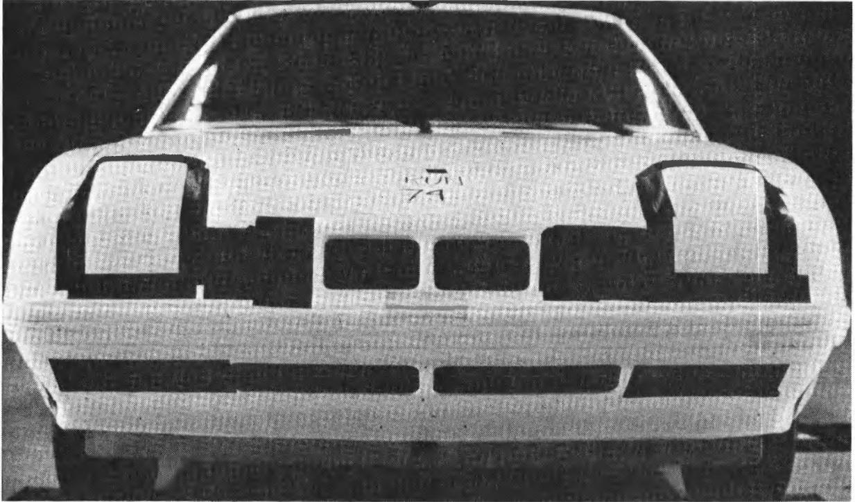
**Figure 106** BLOCKED OUTER COOLING SLOTS
